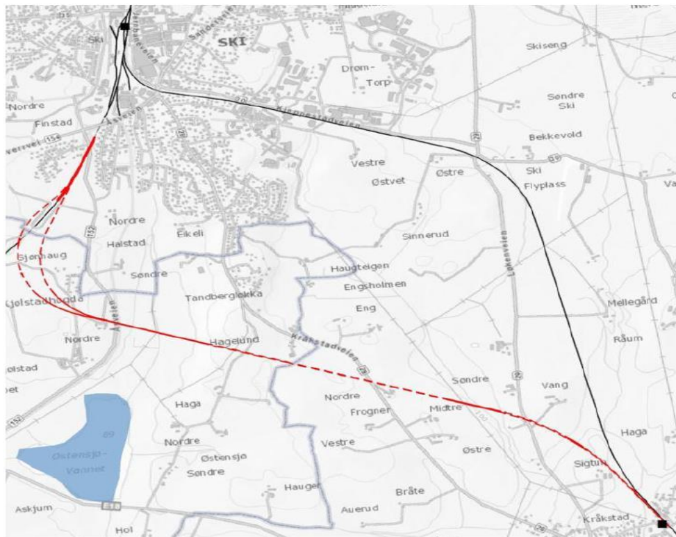
Figur 7-2: Alternativt konsept 1, planskilt påkobling sør for Ski stasjon. Stiplet linje indikerer skjæring.
